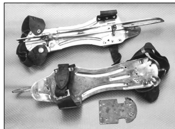
In de voetplaten zitten breuken Deze zijn gerepareerd door een plaatje over deze breuken heen te klinken. Ook ontbreekt er een haksteun. Coll. B.W.v.d.Peppel Foto B.W.v.d.Peppel
