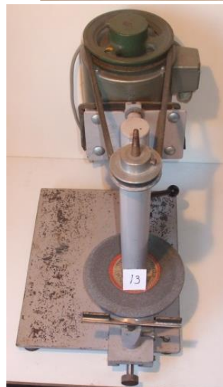
13. Elektrische slijper. Aangekocht in 1951 door mijn vader. Wordt door mij nog steeds gebruikt voor hol- en vlakslijpen. Toeren 3800, Korund en Tyrolit slijpschijven.
