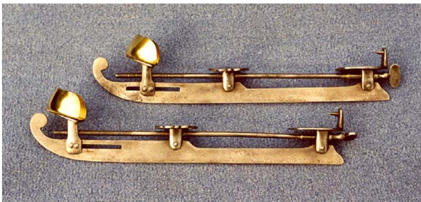
Fraai bewerkte verstelbare schaatsen, die d.m.v. een schroefspindel onder de schoen werd bevestigd (zijaanzicht).
