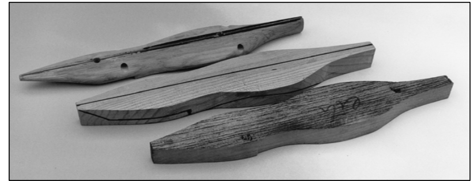
Uitgezaagde en voorgevormde voetstapels van de schaatsen van Hans van Druuten.
