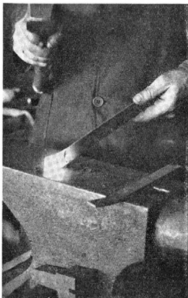
Aan het eene einde van het op maat geknipte stuk staal wordt de eerste vorm aangebracht van de omgebogen neus.
